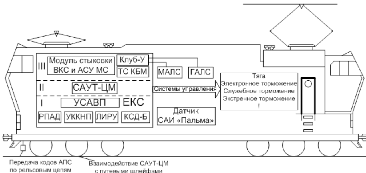
Рисунок 24.1 – Структурная схема обеспечения безопасности на локомотиве
